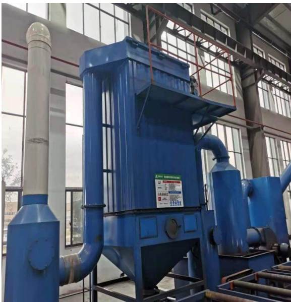
喷砂机自带布袋过滤装置
