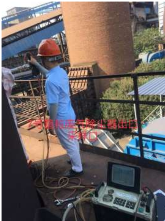
7#整粒废气电袋复合除尘器出口采样口
