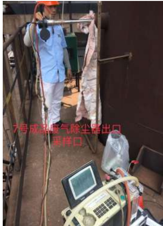
7#成品废气电袋复合除尘器出口采样口
