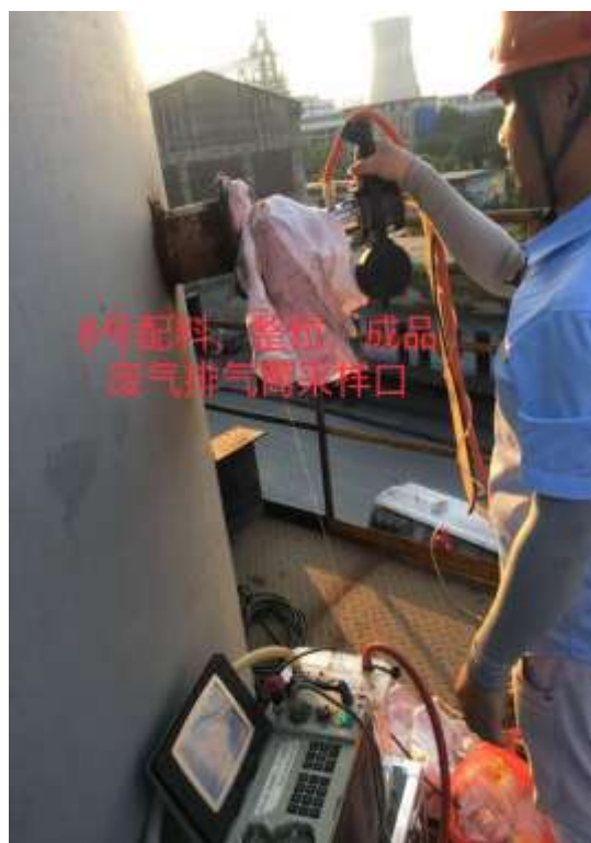
8#配料、整粒、成品废气排气筒处理后采样口
