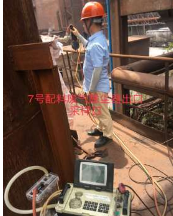
7#配料废气电袋复合除尘器出口采样口
