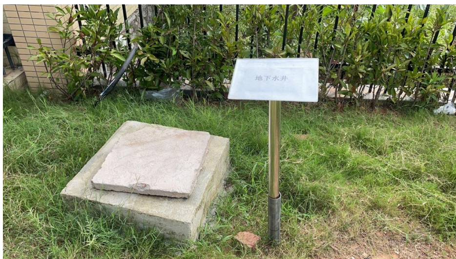
图 4-8 厂区内地下水监控井
