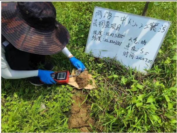
S5-VOCS 快速检测
