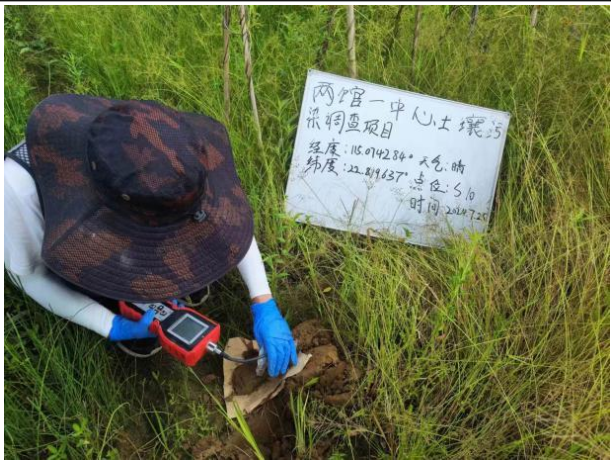
S10-VOCS 快速检测
